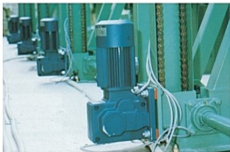
干燥机 使用螺栓直接固定外壳，安装简单。
