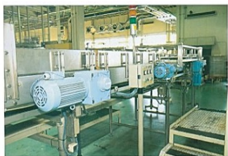
酿酒厂传送流水线 无臂链轮、链条或其他驱动装置
